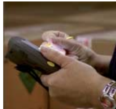
Abb. 6: Funkterminal zur kabellosen Abwicklung von Lageraufgaben.
